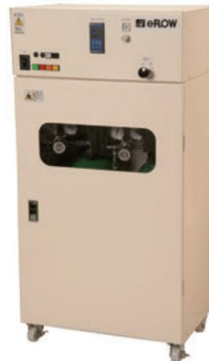
C Series は、CO<sub>2</sub> ポンプ2本を搭載可能なキャビネット付きです。比抵抗センサーをキャビネットに内蔵し、eFLOWより直接ユースポイントへ水配管を接続できます。
